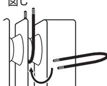
3. 付属のキャスター装着プレート外側の穴にU字ボルトのネジを差し込みます。蝶ナットを時計回りに回転させ取り付けます。（図D）
