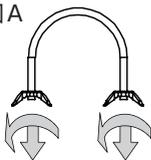
前方から1番目（フロントカバーの裏側）と2番目のフィンの間（図B）に付属のU字ボルトを通します。（図C）
